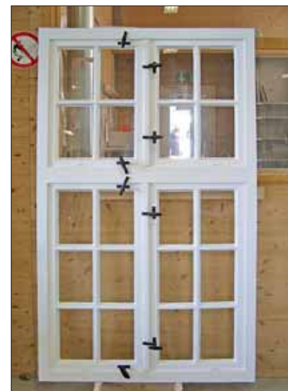
Die Oberflächenbehandlung erfolgte mit Standölfarben, die aus nachwachsenden Rohstoffen wie Leinöl und Tungöl bestehen. Die Farbschicht lässt zu, dass Feuchtigkeit von innen nach außen entweicht, statt das Holz zu versiegeln, was zu Fäulnis führen kann.
