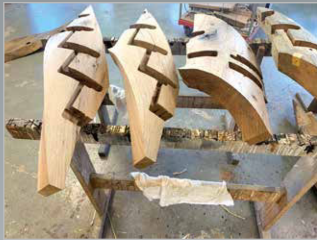
Für die Innenwanne der Wendeltreppe aus dem Bergfried wurden in der Werkstatt in Lemgo die Krümmlinge aus historischen Eichenbalken rekonstruiert.
