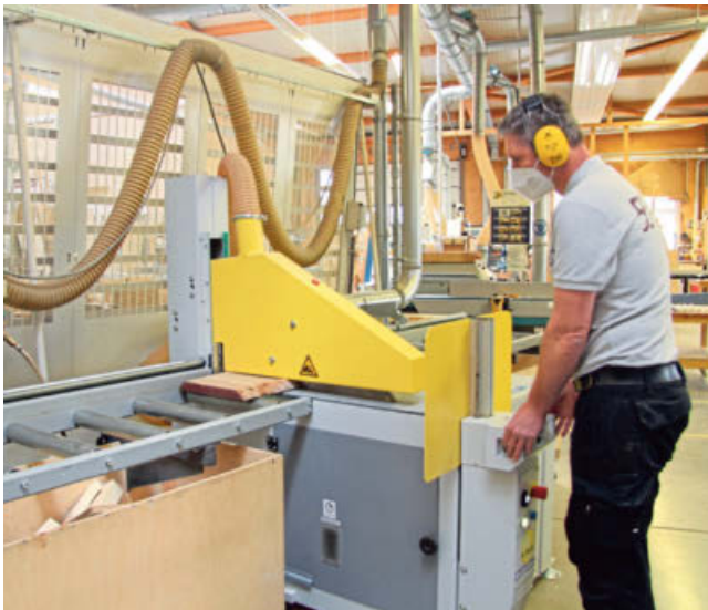
Tischlerei-Leiter Dieter Nagel steht an der neuen Untertisch-Kappsäge, die für mehr Sicherheit bei der Arbeit bei Kramp & Kramp sorgt.
