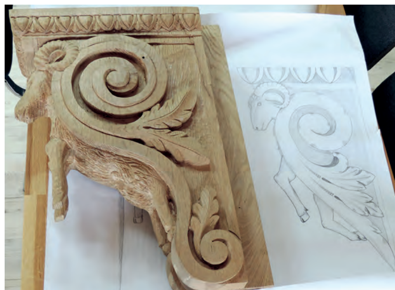
Bei allen Schnitzereien wurden Skizzen in Originalgröße als Vorlage erstellt.
