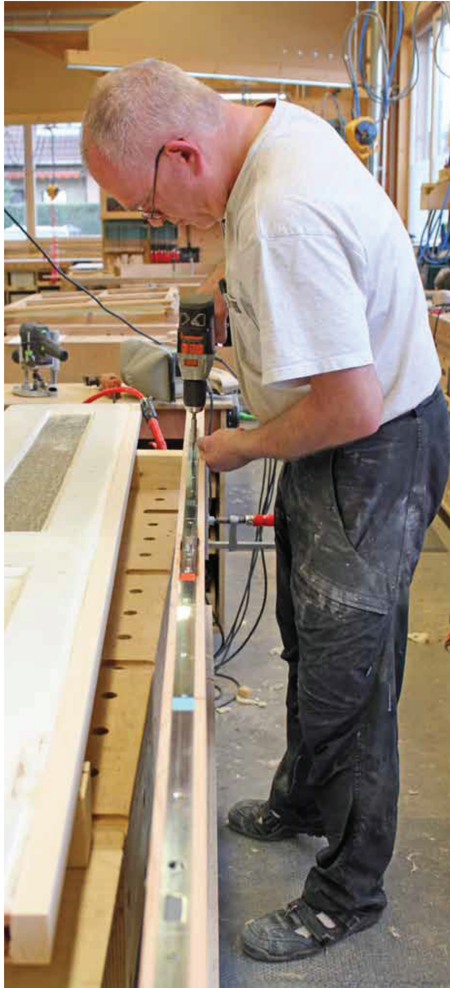
Tischlermeister Johannes Stute leimt an den schmalen feststehenden Flügel eine 25 mm dicke Leiste aus Kiefernholz an
