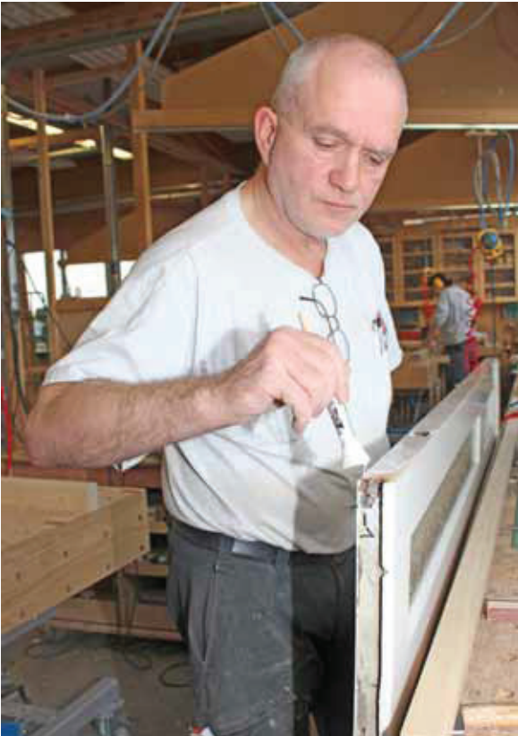
Tischlermeister Johannes Stute leimt an den schmalen feststehenden Flügel eine 25 mm dicke Leiste aus Kiefernholz an
